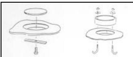
Bauen Sie den Anschlusskragen mit Hilfe mit den zwei mitgelieferten Schlussteilen an der Innenseite und den zwei Muttern an der Aussenseite. Beachten Sie die richtige Stelle der Schlussteile in der dazu vorgesehenen Spalte auf der linken und rechten Seite des Lochs. Sorgen Sie für eine richtige Dichtung zwischen dem
