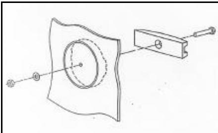
Setzen Sie dann das Werkzeug mit den Bolzen auf die Innenseite des Deckels. Bringen Sie Schlussring und Mutter an und ziehen Sie diese an. Mit einem Ringschlüssel drehen Sie die Mutter an bis das Deckel ausrichtet.
