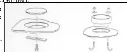
Om het eventuele uitgeslane gat te dichten is er nog een deksel bijgevoegd dat met een plaatstaal plaatje en bout M6x25 vast gezet kan worden. Voor de afdichting van de aansluitkraag en de afdekplaat gebruikt U de bijgevoegde kit.
