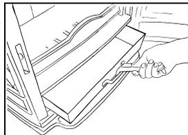
Van hout hebt u relatief weinig assen en is het niet nodig uw toestel elke keer te ontassen, het stoken van hout in een asbed geeft overigens een betere verbranding. Bij kolenstook moet regelmatig ontast worden en de aslade tijdig geleidigd worden. De assen mogen de onderzijde van het stookrooster NOOIT raken.
