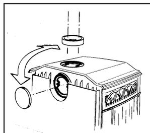
Sorgen Sie für eine gute Abdichtung des Anschlusskragens und Deckels am Gerät, und zwar mit beiliegendem Kit oder Pasta.
