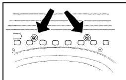
A la fin de la saison de chauffe, boucher le conduit de fumée avec du papier journal. C'est le moment de faire un nettoyage de l'intérieur du foyer. Au besoin, remplacez les cordons d'étanchéité de la porte et mastiquez d'éventuelles fentes. Pour un nettoyage approfondi déposez également le déflecteur suspendu dans la partie supérieure du corps de chauffe.
