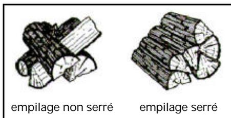
Un empilage serré donnera une combustion plus lente car l'oxygène ne pourra pas atteindre toutes les bûches en même temps. C'est l'empilage conseillé pour des périodes de chauffe de longue durée.
